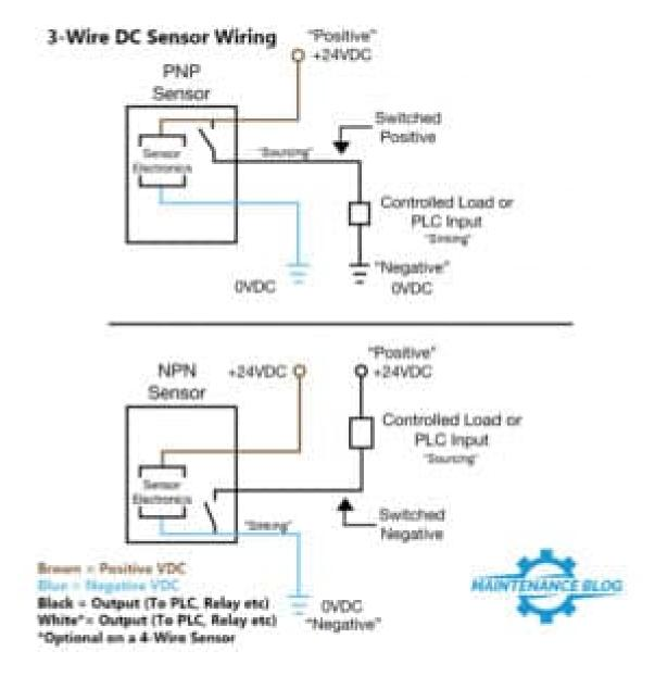
PNP v.s NPN Sensor Wiring
