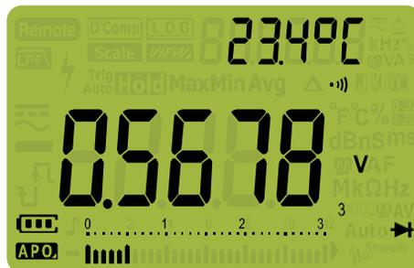
**Figure 2-19** Diode display
